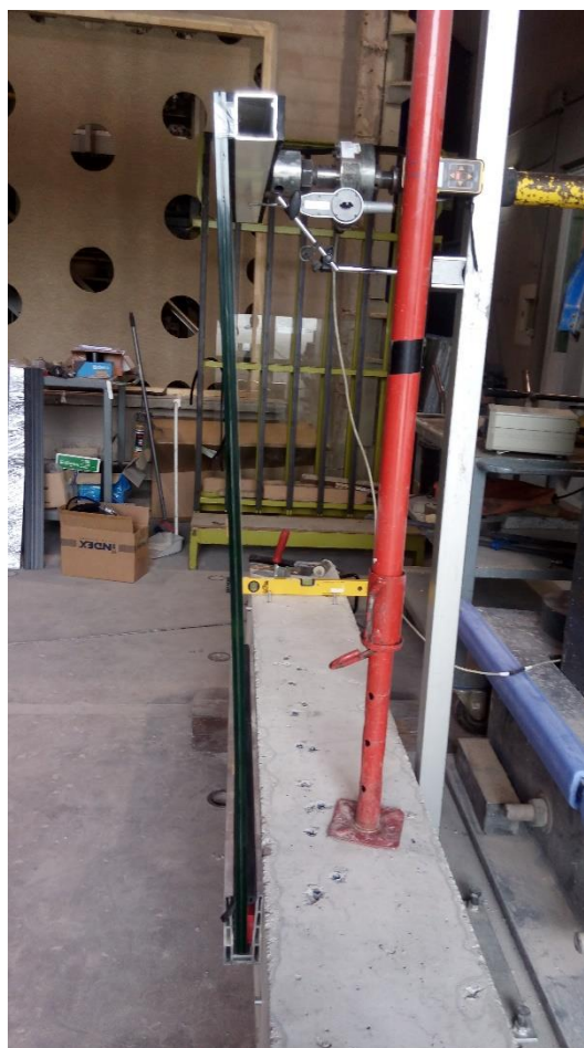
Vista de la barandilla puesta en carga
