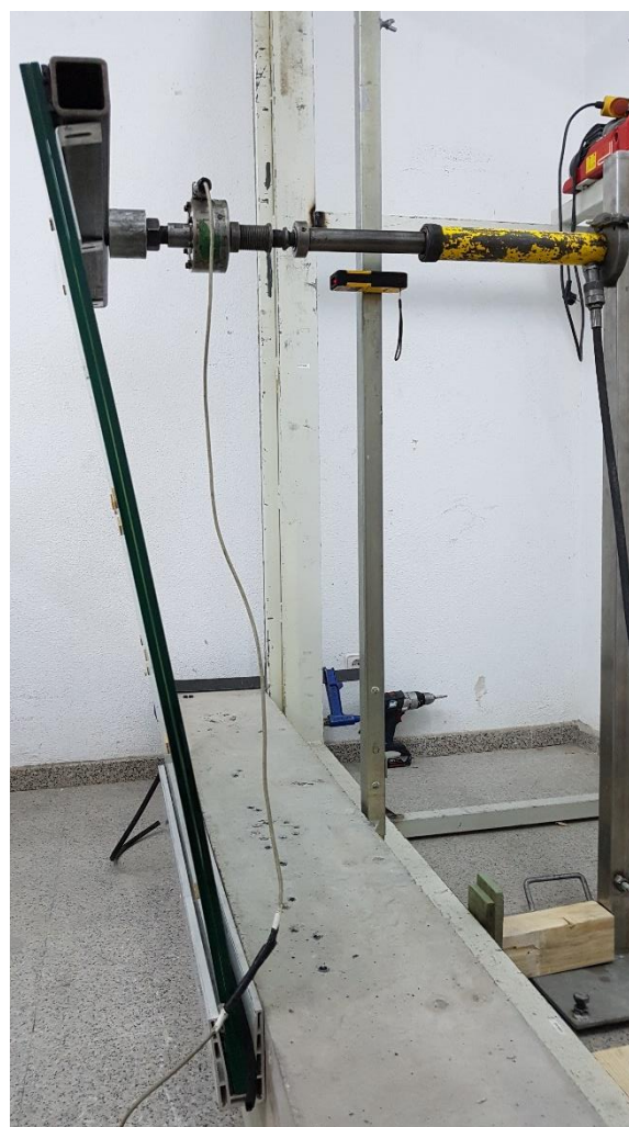
Vista de la barandilla puesta en carga
