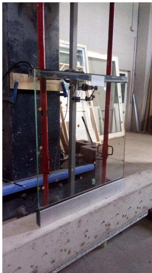
Vista de la barandilla puesta en carga
