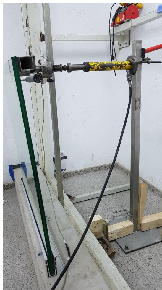
Vista de la barandilla puesta en carga
