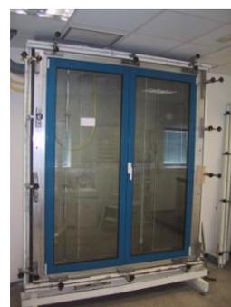
**Permeabilidad al aire****CLASE 4****Estanquidad al agua****CLASE E<sub>900</sub>****Resistencia a la carga de viento****CLASE C1**
