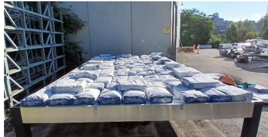
*Imagen de la muestra en máxima carga de nieve*
