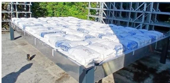
*Imagen de la muestra en máxima carga de nieve*
