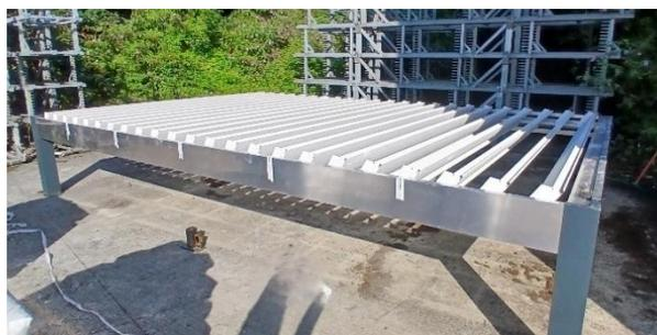
Imagen de lamas abiertas tras el ensayo
